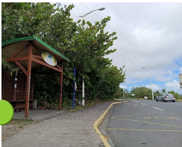
Abri + poteau + zigzag permettent ici de repérer aisément le PA Bois Jolan – Sainte Anne
