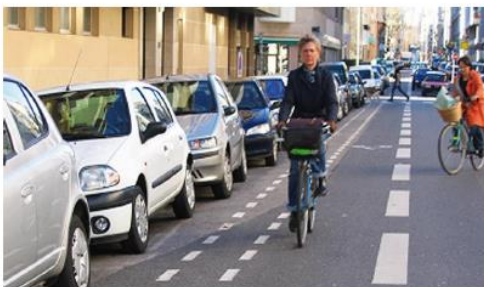
Bande cyclable avec espace tampon de 0,5 m
