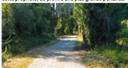
Exemple de revêtement minéral perméable pour voie cyclable (© PBC - Robin Dagois)
